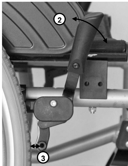
Uvolněná brzda (vozík se může pohybovat)
