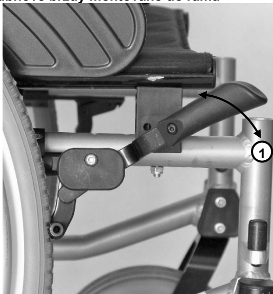
Zatažená brzda (vozík se nepohybuje)
