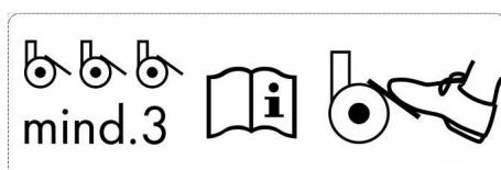
Část C: Obr.1: Brzdění pojezdových koleček
