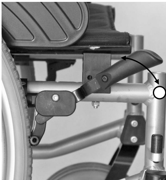
Bremse blockiert (der Rollstuhl kann nicht fahren)
