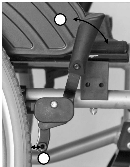
Hamulec odblokowany (wózek może jechać)
