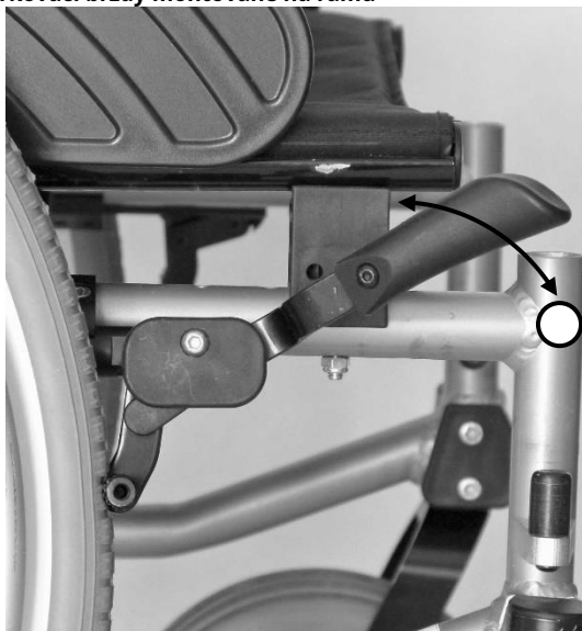
Brzda zapnutá (invalidní vozík nejede)
