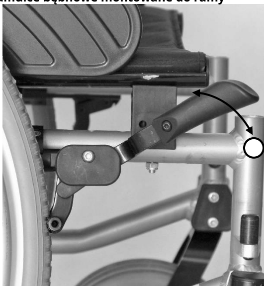
Hamulec zablokowany (wózek nie może jechać)
