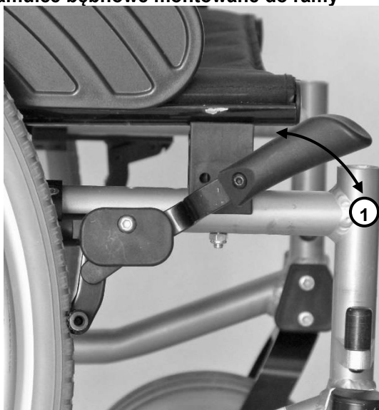
Hamulec zablokowany (wózek nie może jechać)
