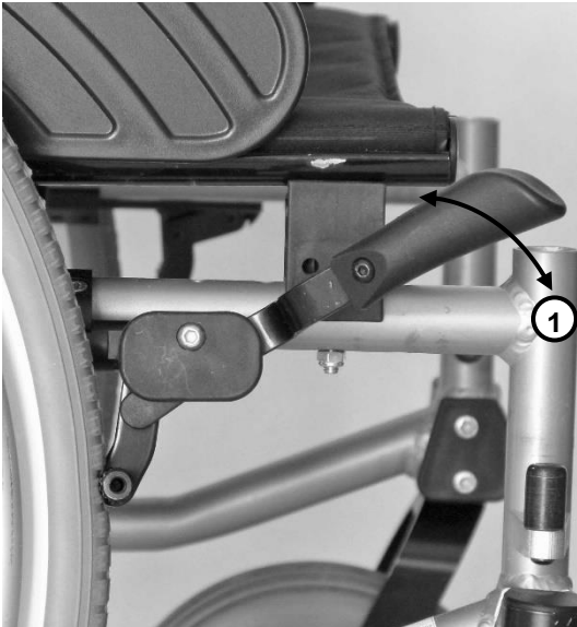
Bremse blockiert (der Rollstuhl kann nicht fahren)
