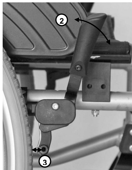
Hamulec odblokowany (wózek może jechać)
